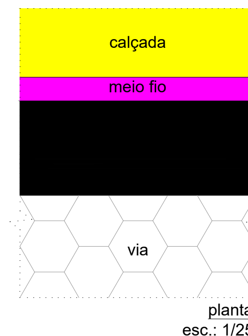
DETALHES 1 e 2: PAGINAÇÃO PARA ASSENTAMENTO DOS PAVERS
